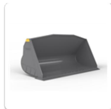
Die beste Universalschaufel. Versehen mit U-Messer können loses Material und Zuschlagstoffe in kurzen Arbeitszyklen sowie Transportvorgängen gehandhabt werden. Bei einer Ausrüstung mit angeschweißten Zähnen und geschraubten Segmenten stellt diese die beste Wahl für das Beladen von gebrochenem Material dar. Ideal für raue Anwendungen, in denen eine lange Lebensdauer und geringe Abnutzung erforderlich sind.
